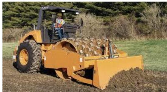
*Imagen B.4- Movimiento de suelos, nivelación con motoniveladora y compactación con rodillo pata de cabra.*
